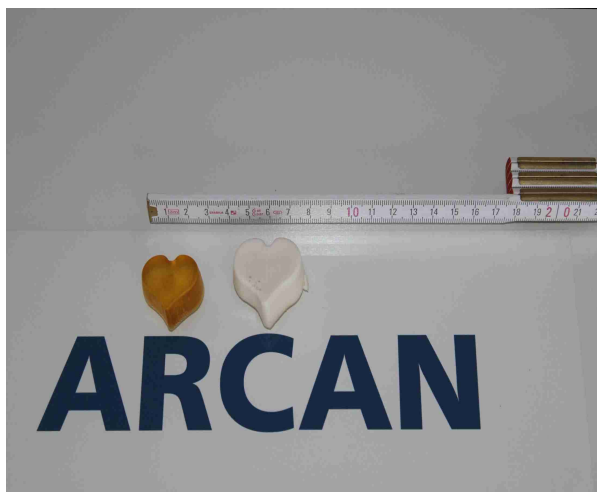
Żywica Integral po kontakcie z wodą. Pęcznienie ok. 120%
